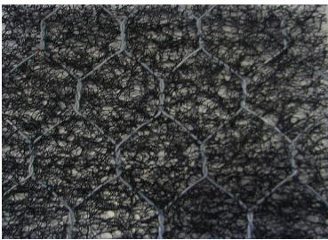
图8 三维加筋网垫示意图
