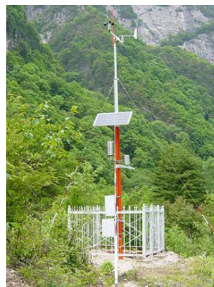
图4 设立风速气象站
